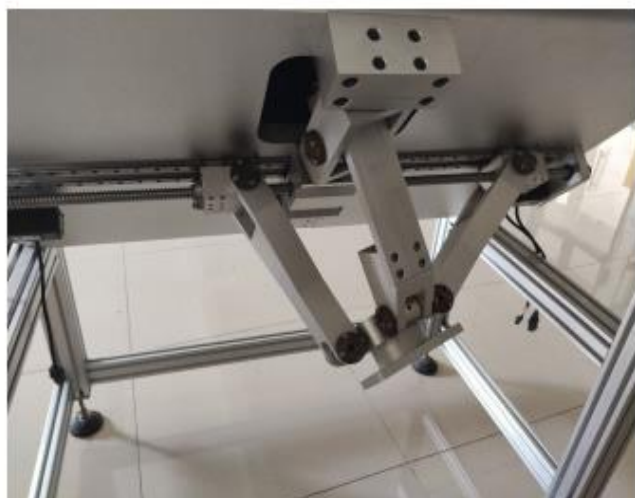
Рисунок 4 – прототип параллельного механизма с тремя степенями свободы [5]
