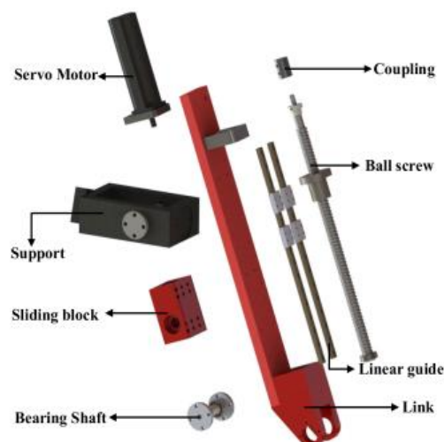
Рисунок 4 – прототип параллельного механизма с тремя степенями свободы [5]
