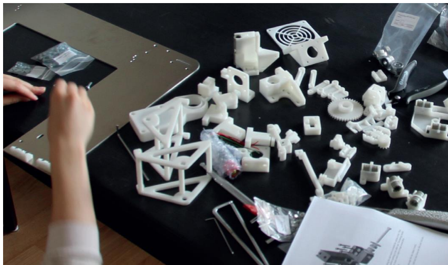
Рис. 2 – Процесс создания одного 3D-принтера с помощью другого Fig. 2 - The process of creating one 3D printer with another
