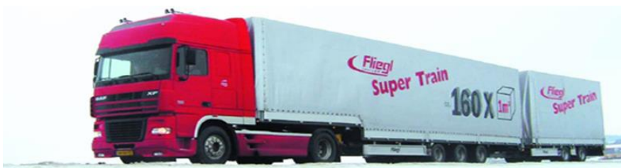
2 сурет - Ұзындығы 25,25 м, шанақ көлемі 160 м 3 орнатпа-тіркемелі автопоезд
