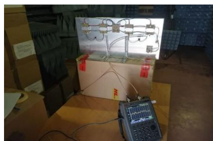
б) Антенна бір элементінің ТТҚ өлшеу
