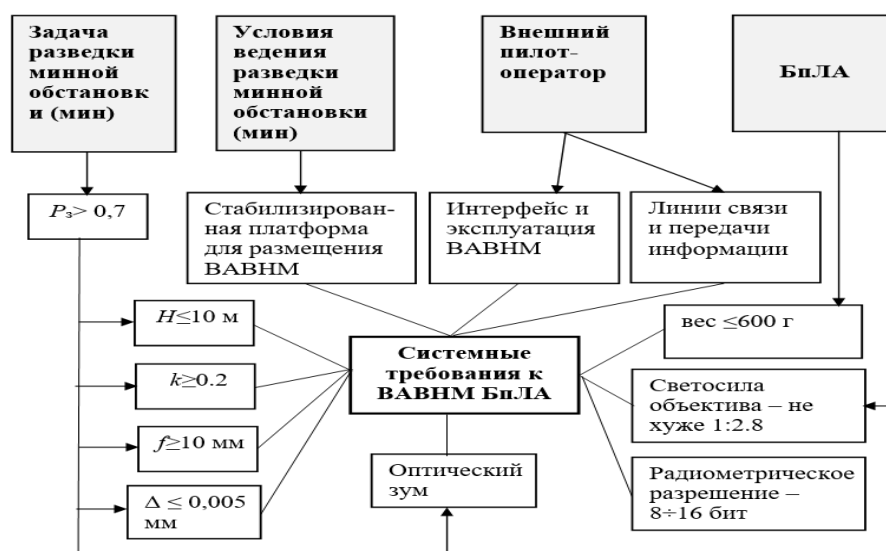
Рисунок 3 – Схема методики формирования совокупности системных требований к цифровым аэрофотокамерам, устанавливаемым на БпЛА для выявления наземных мин.
