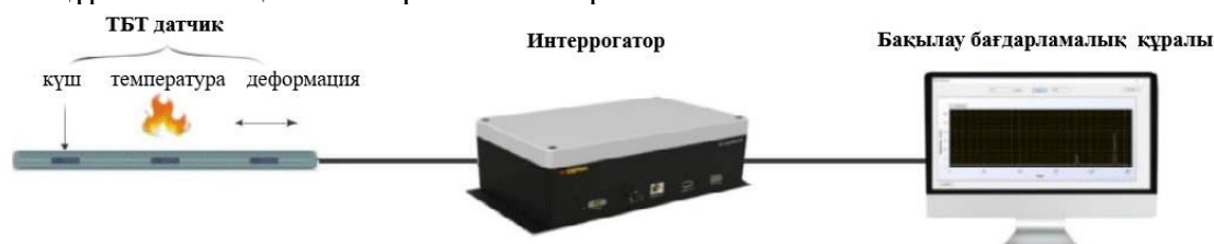
7 сурет – Өртүрлі параметрлерді өлшеуге арналған ТБТ негізіндегі талшықты датчик жалпылама конфигурациясы
