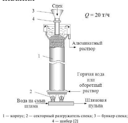
Figure 4 – Leaching process depending on the grade of ore and the size of grinding Рисунок 4 – Процесс выщелачивания в зависимости от сорта руды и размера измельчения
