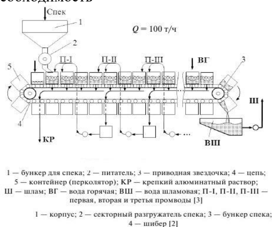
Figure 3 – Leaching process depending on the grade of ore and the size of grinding Рисунок 3 – Ленточный выщелачиватель
