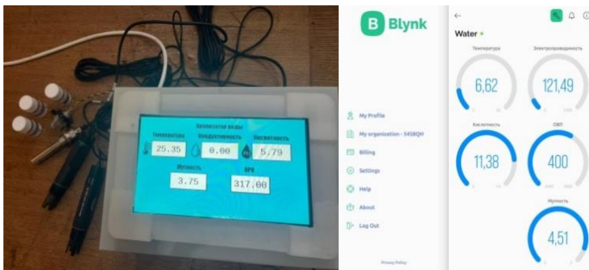
1 сурет – Біріктірілген өлшеу деректерін жинауға және беруге арналған жүйе
