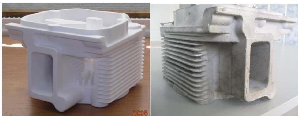
Рисунок 2 - Полистирольная модель и отливка головки цилиндра ДВС Figure 2 - Polystyrene model and casting of the cylinder head of an internal combustion engine
