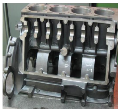
Рисунок 1 - Блок цилиндров: а – Quick-cast модель; б – чугунная отливка Figure 1 - Cylinder block: a - Quick-cast model; b - cast iron casting
