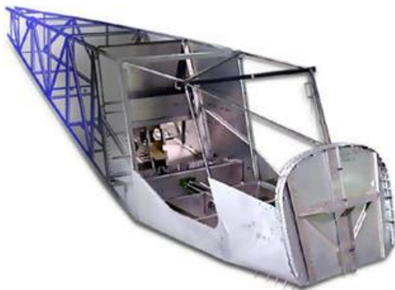
Рисунок 2 – Каркас фюзеляжа самолета «Арай»
