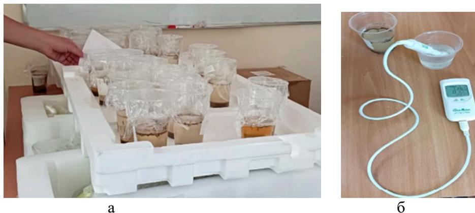
Рисунок 3 – Сбор образцов почвы: а – отстаивание раствора, б – процесс калибровки для измерения электропроводности почвы
