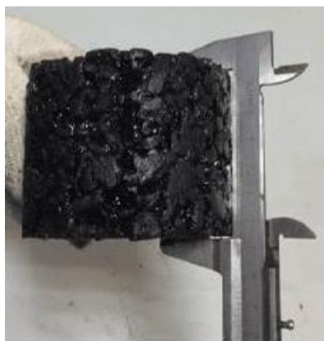
Рисунок 5 – Измерение высоты переформованного образца штангенциркулем
