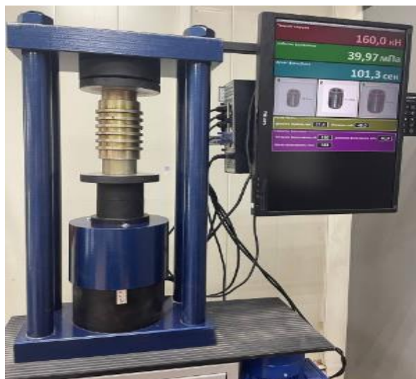
Рисунок 4 - Уплотнение смеси на гидравлическом прессе
