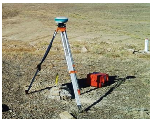
Рисунок 2 - Спутниковая геодезическая аппаратура (приемники GPS) для определения планового положения пунктов опорной геодезической сети
