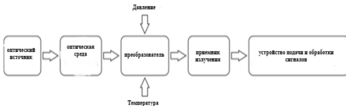
Рисунок 1 – Структурная схема волоконно-оптических датчиков (собственный чертеж)
