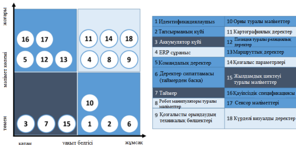
7 сурет - Мобильді роботты пайдалану мысалдарын талдау барысында анықталған деректер көлемі және ақпараттың нақты уақыт талаптары
