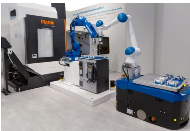
5 сурет - Мобильді роботтық жүйемен машиналарға техникалық қызмет көрсету
