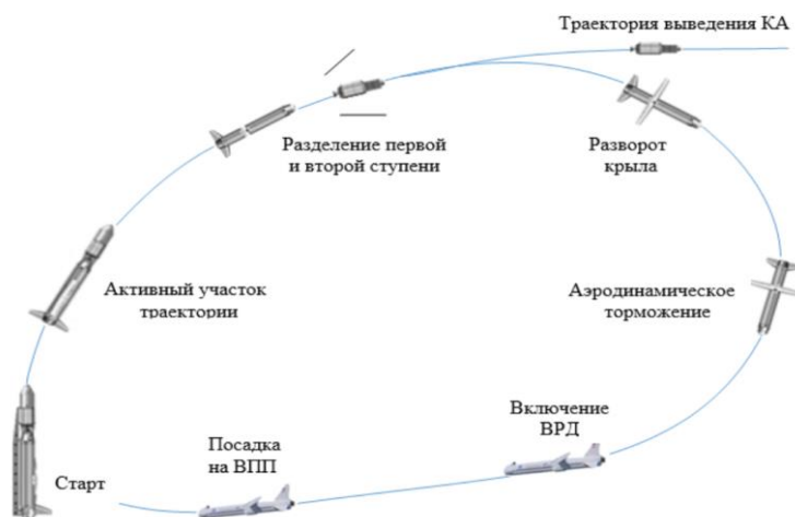
Рисунок 11 – Схема возврата нижней ступени РН СЛК на взлетно-посадочную полосу
