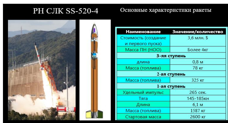
Рисунок 1 - Трехступенчатая твердотопливная РН СЛК SS-520-4
