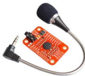
2 сурет - Дауыстық аутентификациялық жүйесін дыбыстық сигналдар іске асыруға арналған микрофон мен MT Technology Co., Ltd. V3 модулем біріктірілен платаның көрінісі
